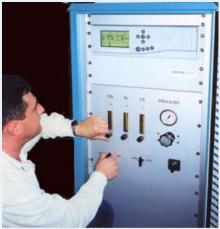
Модель MOD-1002 «Системы непрерывного мониторинга газообразных выбросов» представляет собой комплексную измерительную систему, объединяющую в одном шельтере анализаторы, подготовку и очистку образцов и вывод данных. Система включает в себя инфракрасные/парамагнитные анализаторы и усовершенствованную модель подготовки образцов для проведения точных и надежных измерений одновременно до шести измеряемых компонентов:  $O_2$ , CO,  $CO_2$ ,  $NO_x$ ,  $SO_2$ , and  $CH_4$ .
