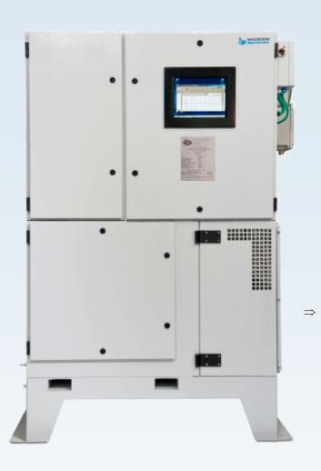
Поточные измерения содержания соли в сырой нефти играют важную роль на всем пути нефтяного сырья от нефтяной скважины до установки перегонки сырой нефти. *МОД-4100 S* представляет собой поточный анализатор содержания соли в сырой нефти, предназначенный для выполнения измерений в режиме реального времени. Измерения основаны на электрометрическом методе (ASTM D 3230), когда концентрация соли определяется по проводимости сырой нефти, растворенной в смеси спиртовых и ароматических растворителей.
