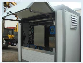
**ПОТОЧНАЯ СИСТЕМА АНАЛИЗА КАЧЕСТВА ПРИРОДНОГО ГАЗА** *модель МОD-1022* предназначена для поточного измерения следующих качественных характеристик природного газа:
