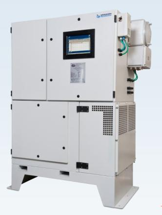
Анализатор серы MOD-6400 представляет собой систему одно- или многопоточного анализа, которая обеспечивает конечного пользователя множеством каналов связи для осуществления эффективного функционирования системы. В дополнение к традиционным выходам 4-20 mA для оперативного контроля общего содержания серы, MOD-6400 способен также предоставить ряд дискретных входов и выходов, а также возможности связи в двух направления через RS-232/RS-485 и Ethernet.
