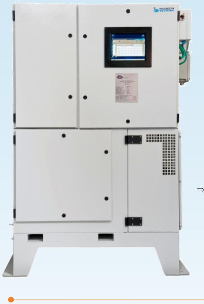
Поточные измерения содержания соли в сырой нефти играют важную роль на всем пути нефтяного сырья от нефтяной скважины до установки перегонки сырой нефти. **MOD-4100 S** представляет собой поточный анализатор содержания соли в сырой нефти, предназначенный для выполнения измерений в режиме реального времени. Измерения основаны на электрометрическом методе (ASTM D 3230), когда концентрация соли определяется по проводимости сырой нефти, растворенной в смеси спиртовых и ароматических растворителей.
