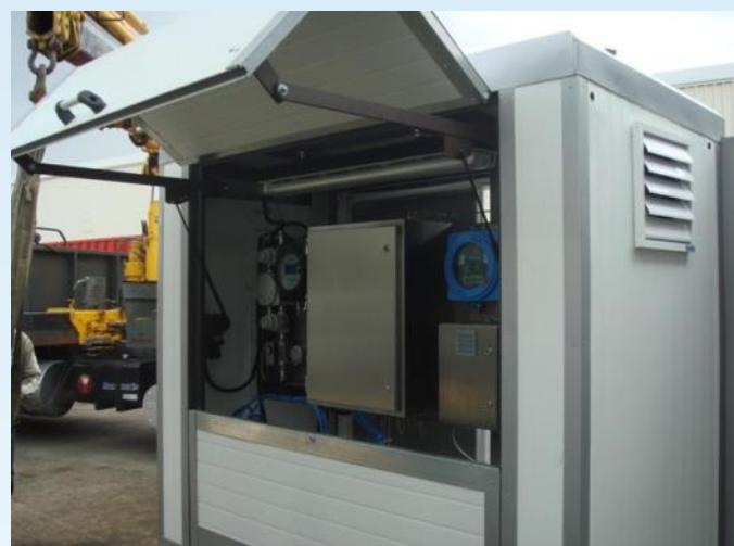
**ПОТОЧНАЯ СИСТЕМА АНАЛИЗА КАЧЕСТВА ПРИРОДНОГО ГАЗА модель MOD-1022** предназначена для поточного измерения следующих качественных характеристик природного газа:
