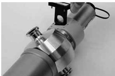
Рис. 3. Использование эталонного цветового фильтра для калибровки датчика
