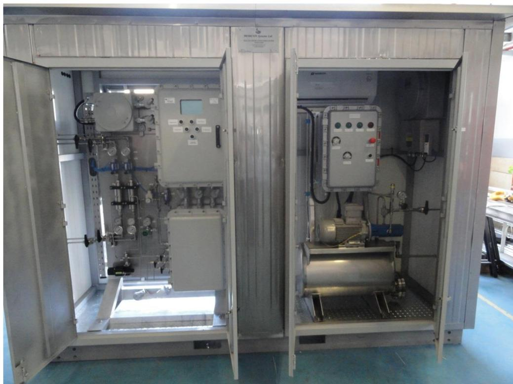
*Изображение.5 – Промышленное взрывозащищенное исполнение аналитической системы MOD - 4100 в обогреваемом шкафу в комплектации системы сбора, накопления и возврата отобранных проб в процесс.*
