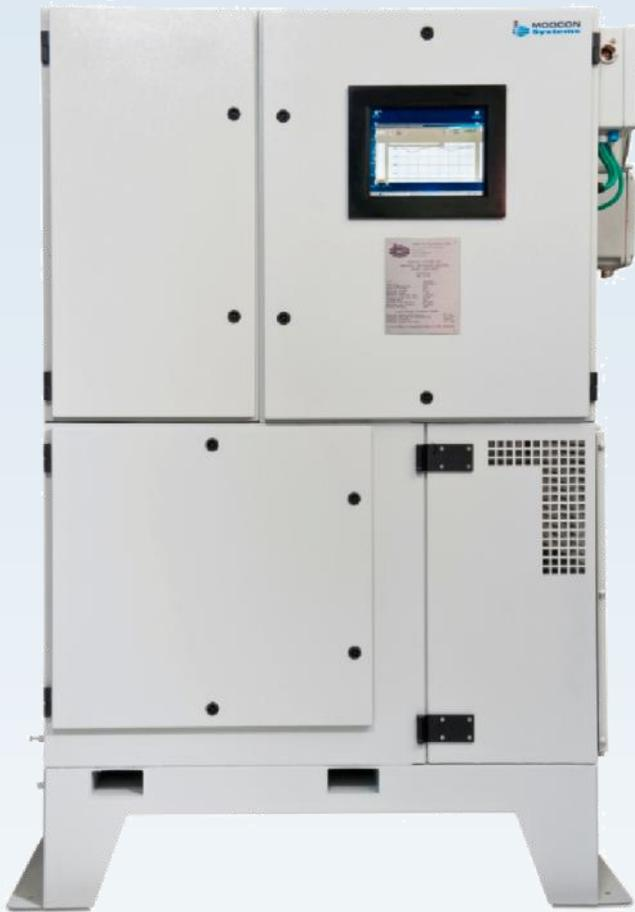
Поточные измерения содержания соли в сырой нефти играют важную роль на всем пути нефтяного сырья от нефтяной скважины до установки перегонки сырой нефти. **MOD-4100 S** представляет собой поточный анализатор содержания соли в сырой нефти, предназначенный для выполнения измерений в режиме реального времени. Измерения основаны на электрометрическом методе (ASTM D 3230), когда концентрация соли определяется по проводимости сырой нефти, растворенной в смеси спиртовых и ароматических растворителей.
