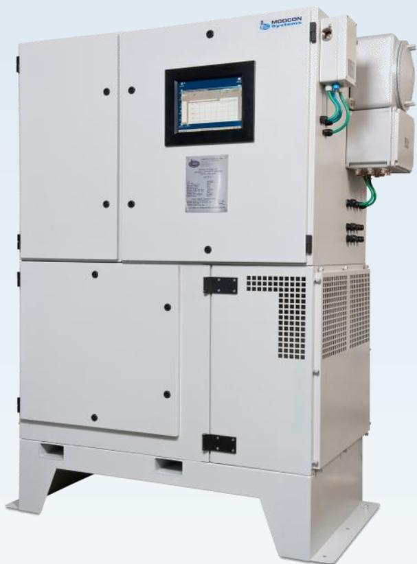
Анализатор серы MOD-6400 представляет собой систему одно- или многопоточного анализа, которая обеспечивает конечного пользователя множеством каналов связи для осуществления эффективного функционирования системы. В дополнение к традиционным выходам 4-20 mA для оперативного контроля общего содержания серы, MOD-6400 способен также предоставить ряд дискретных входов и выходов, а также возможности связи в двух направлениях через RS-232/RS-485 и Ethernet.
